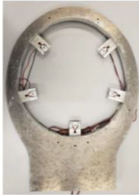
5-LEDs リング状に均等に分配した構成 27)
