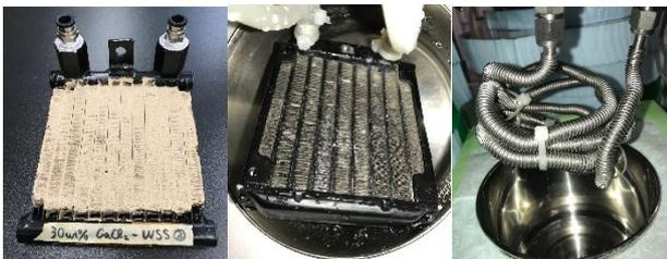
図-3 熱交換器 (左: 吸着器, 中央: 蒸発器, 右: 凝縮器)
